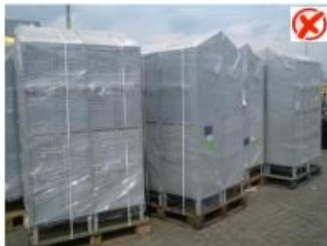
Estructura frágil sin jaba y sin rotulo
