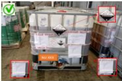
Carga peligrosa debidamente rotulado con rombo
