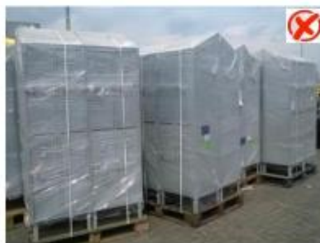
Estructura frágil sin jaba y sin rotulo
