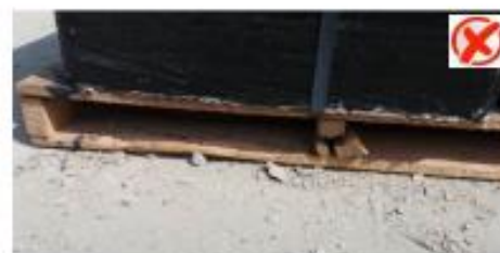
Pallet en mal estado
