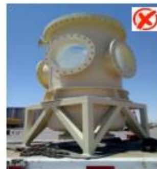
Material sin pallet para manipulación, no es segura la manipulación "fierro con fierro"
