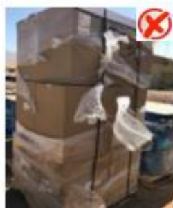
Film dañado y altura super 1,20 mts
