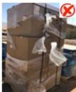
Film dañado y altura super 1,20 mts
