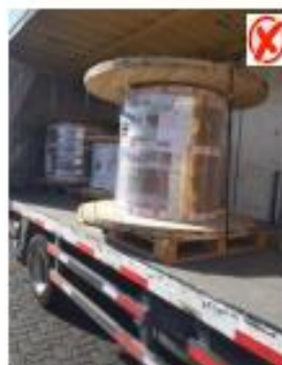
Carga sobresale del pallet
