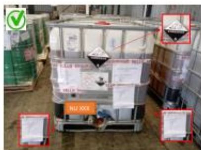
Carga peligrosa debidamente rotulado con rombo
