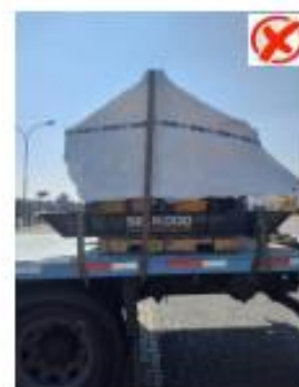
Material no rotulado y no informa el centro de carga, frágil o peso de carga.
