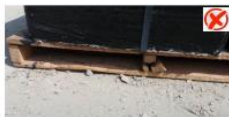
Pallet en mal estado
