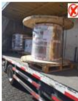
Carga sobresale del pallet
