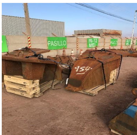
Pallet adaptado a la forma de la coraza
