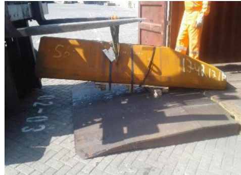
Revestimiento de importación con pallet Palletizar insuficiente para resistir el peso de material
