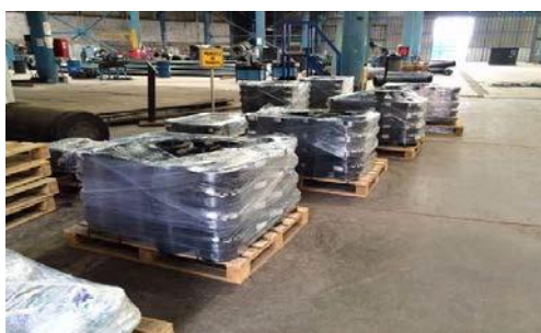
Varias vueltas de film para dar firmeza y estabilidad al material.
